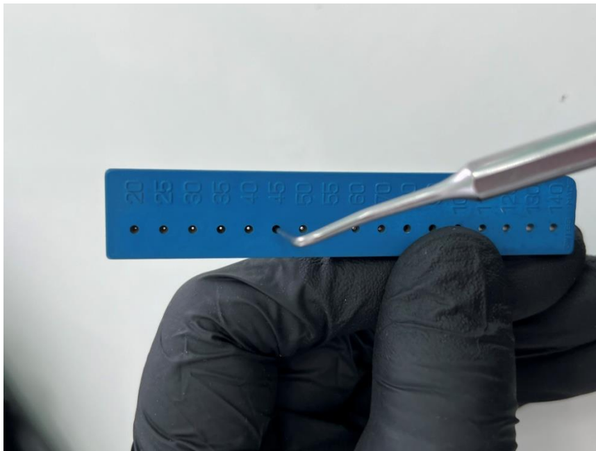
Рисунок 3. Измерение диаметра кончика зондов
